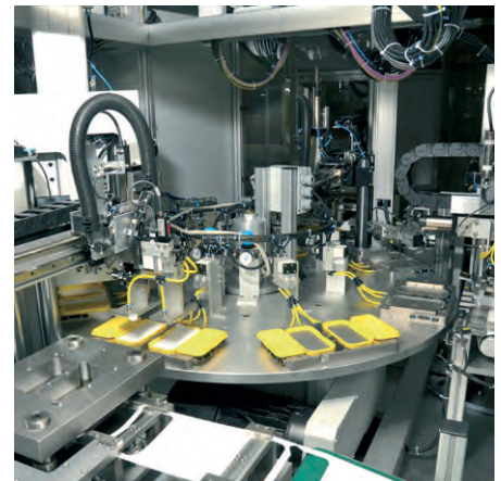
Stanz- und Siegelanlage für Originalitätsverschlüsse in der Lebensmittelindustrie.
